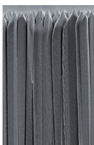
Détecteur à aiguilles (NIP)
